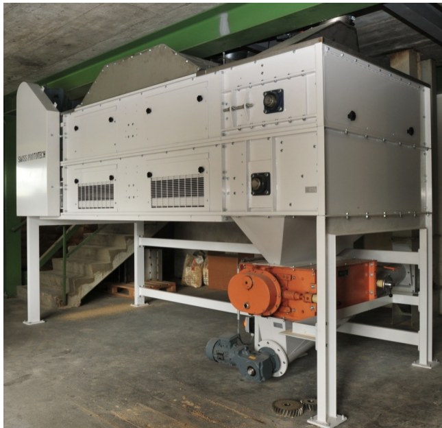
Bandkühler BK 1400-2 mit angebautem Brecher
